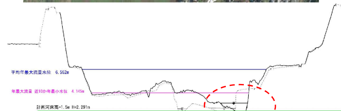
天神川5.0k横断面図(粗い土砂の置土形状)
