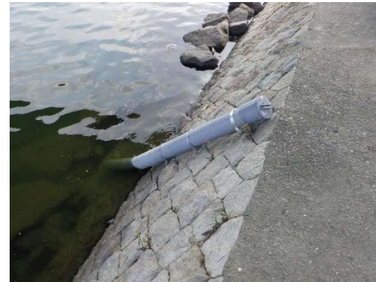
濁度計保護管の設置例
