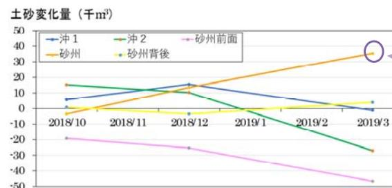
2018. 9を基準とした土砂変化量(深浅測量結果より推定)
