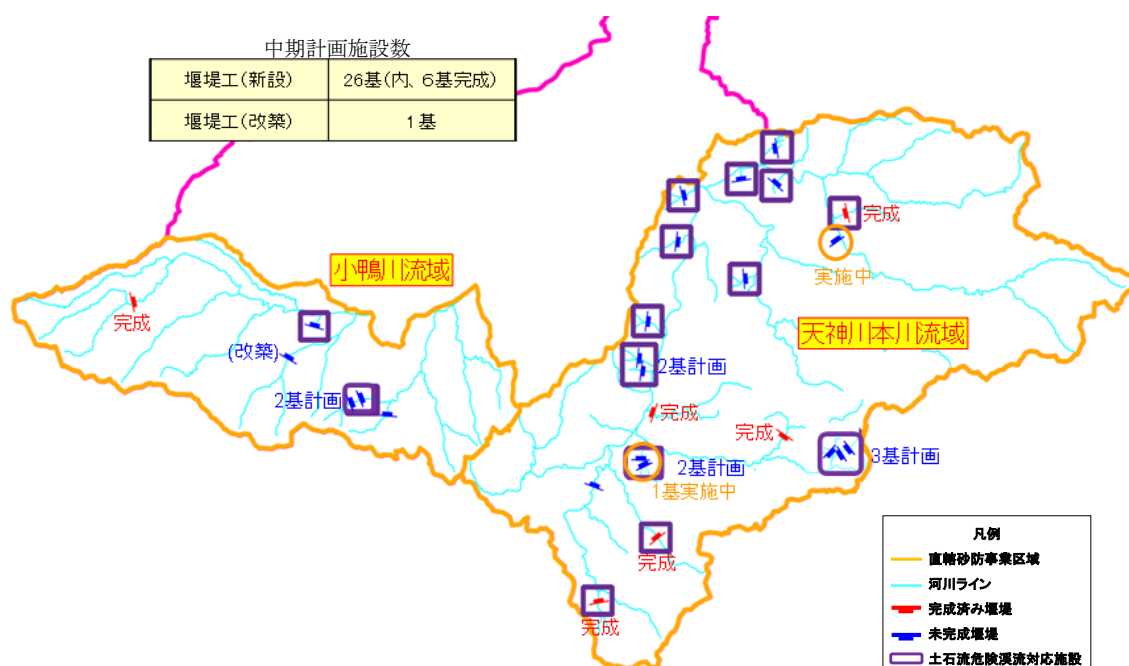
図 5.1-2 中期計画における直轄砂防堰堤の整備
