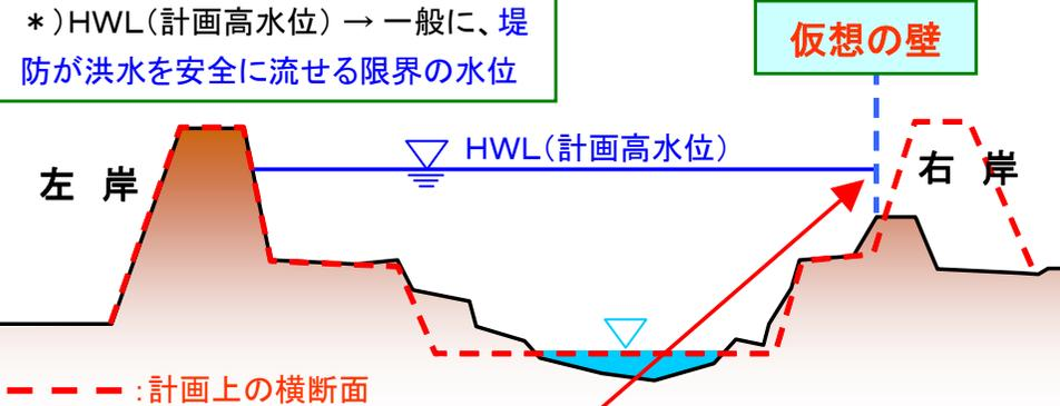
完成していない堤防に「**仮定の壁**」を置き、その壁より河道側の断面で流せる量を「流下能力」とする
