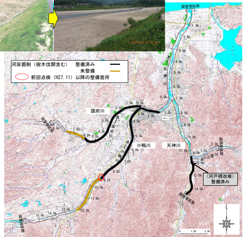
河床掘削の実施状況
