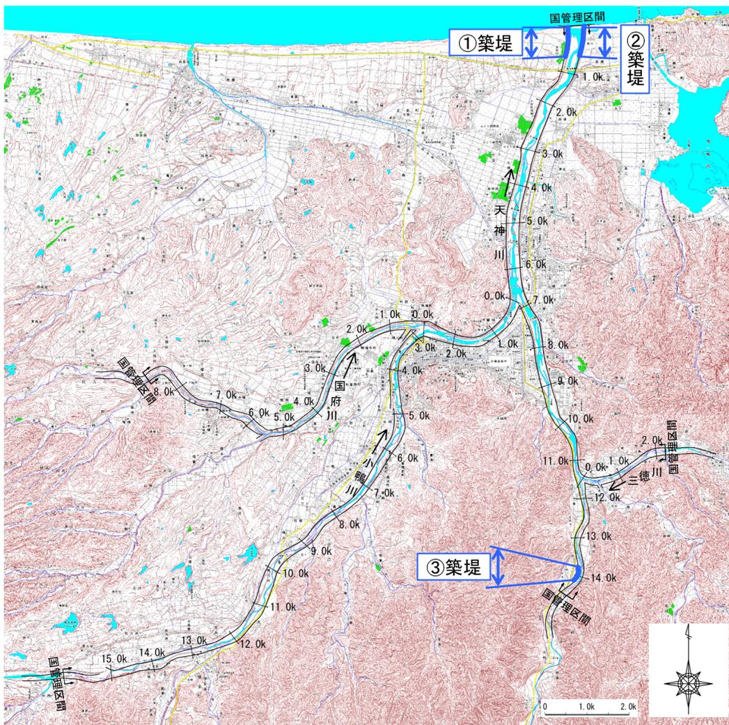
図 5.1.5 堤防の整備を実施する個所の位置図
