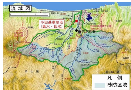
図 2.1.2 天神川流域の国指定の砂防区域
