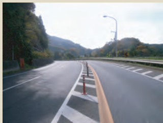
カーブ区間は、中央分離帯、キャッツアイを設置
