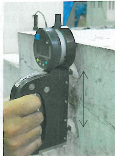
測定範囲約100mm 最小目盛, 0.001mm (ひずみ換算10 \mu )
