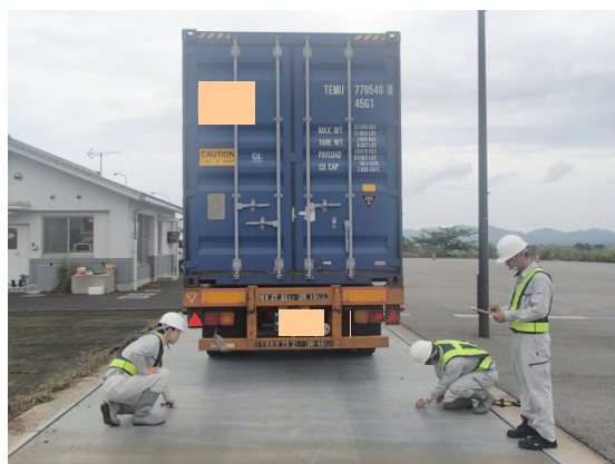
車両寸法計測状況
