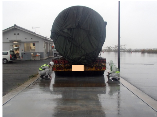
車両寸法計測状況
