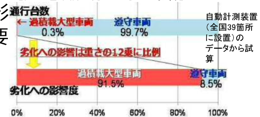
【図 道路橋の劣化に与える影響】
