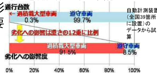
【図 道路橋の劣化に与える影響】
