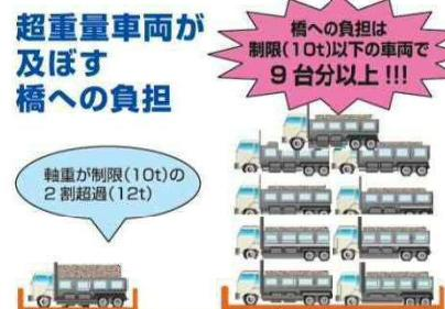
仮に、大型車両1台が、軸重10tの基準よりも2t超過した場合は、舗装に対しては約2台分、RC床版に対しては約9台分の疲労が蓄積されることとなります。
