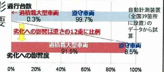
【図 道路橋の劣化に与える影響】
