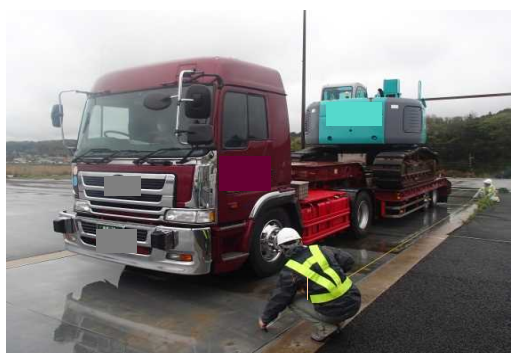
車両寸法計測状況
