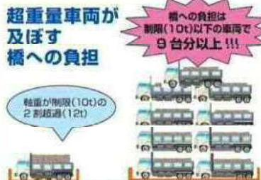
例に、大型車両1台が、軸重10トンの基準よりも2トン超過した場合は、舗装に対しては約2台分、RC床版に対しては約9台分の疲労が蓄積されることとなります。
