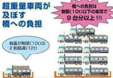
例に、大型車両1台が、橋面10トンの基準よりも2トン超過した場合は、舗装に対しては約2台分、RC床版に対しては約9台分の疲労が蓄積されることとなります。
