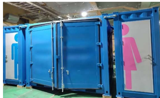
「掛合の里」に設置する防災用コンテナ型トイレ （写真は製作段階のもの）
