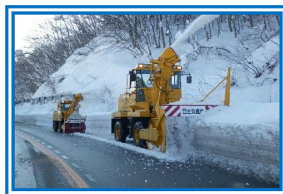
除雪（拡幅除雪）
