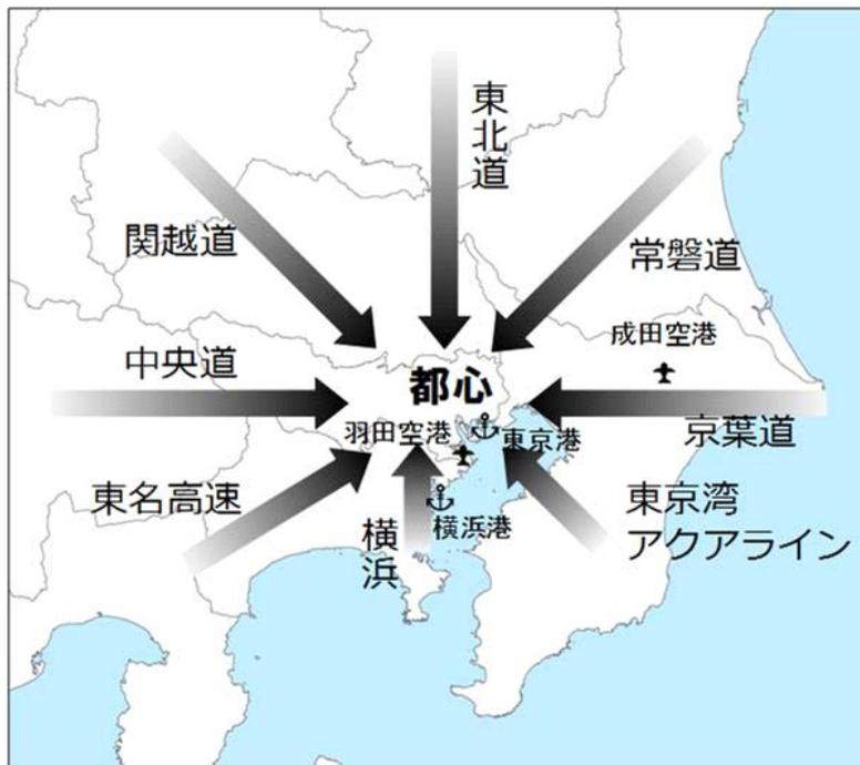
図：首都直下地震に備えた“八方向作戦”による道路啓開
