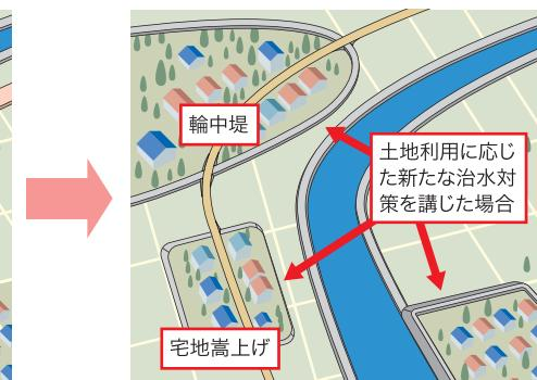
輪中堤や宅地嵩上げを効率的に短期間で実施することにより、家屋の浸水被害を解消
