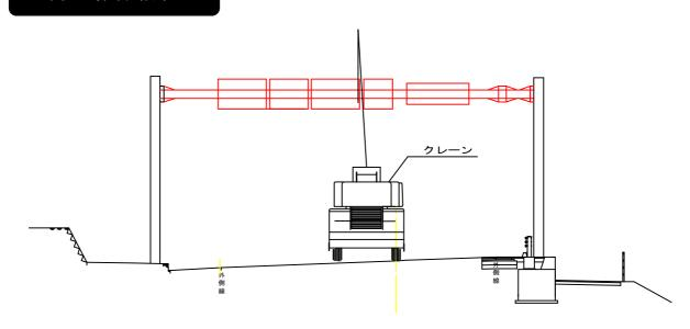
工事内容: クレーンによる門型標識の設置
