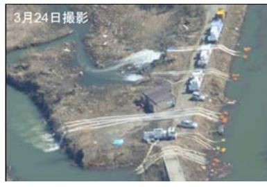
津波により排水路に瓦礫が散乱。一部は水路に埋没。
