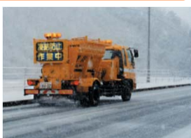
凍結防止剤の散布作業状況
