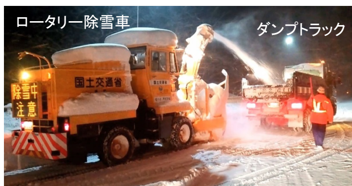
ロータリー除雪車を用いてダンプトラックへ積み込み
