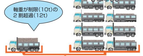
仮に、大型車両1台が、軸重10トンの基準よりも2トン超過した場合は、舗装に対しては約2台分、RC床版に対しては約9台分の疲労が蓄積されることとなります。
