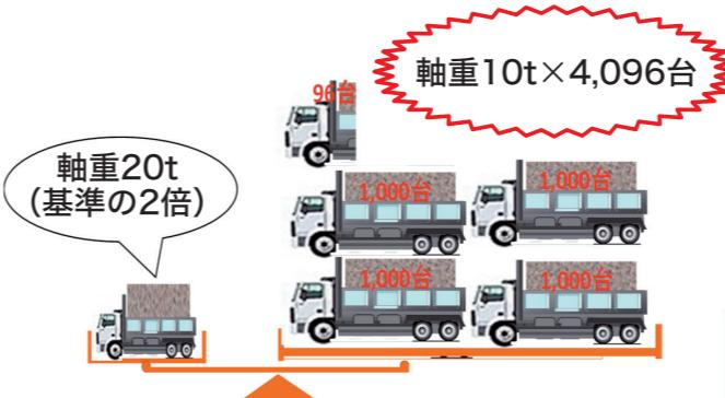
軸重が20トンの車両は、橋(RC床版)に対して軸重10トンの車両約4,000台分の疲労を蓄積することになります。
