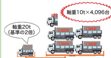
軸重が20トンの車両は、橋(RC床版)に対して軸重10トンの車両約4,000台分の疲労を蓄積させることになります。
