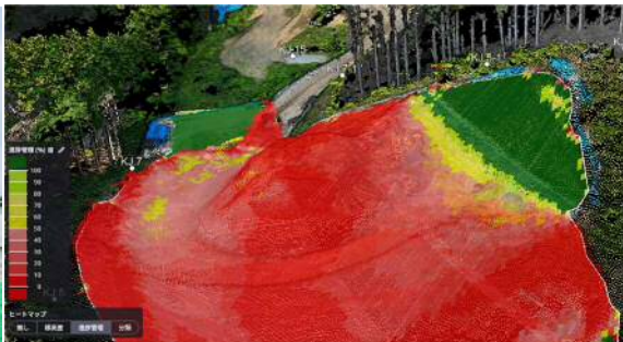
遠隔自動航行ドローンの活用（効率的な点群データの取得）
