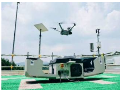
遠隔自動航行ドローンの活用（効率的な点群データの取得）
