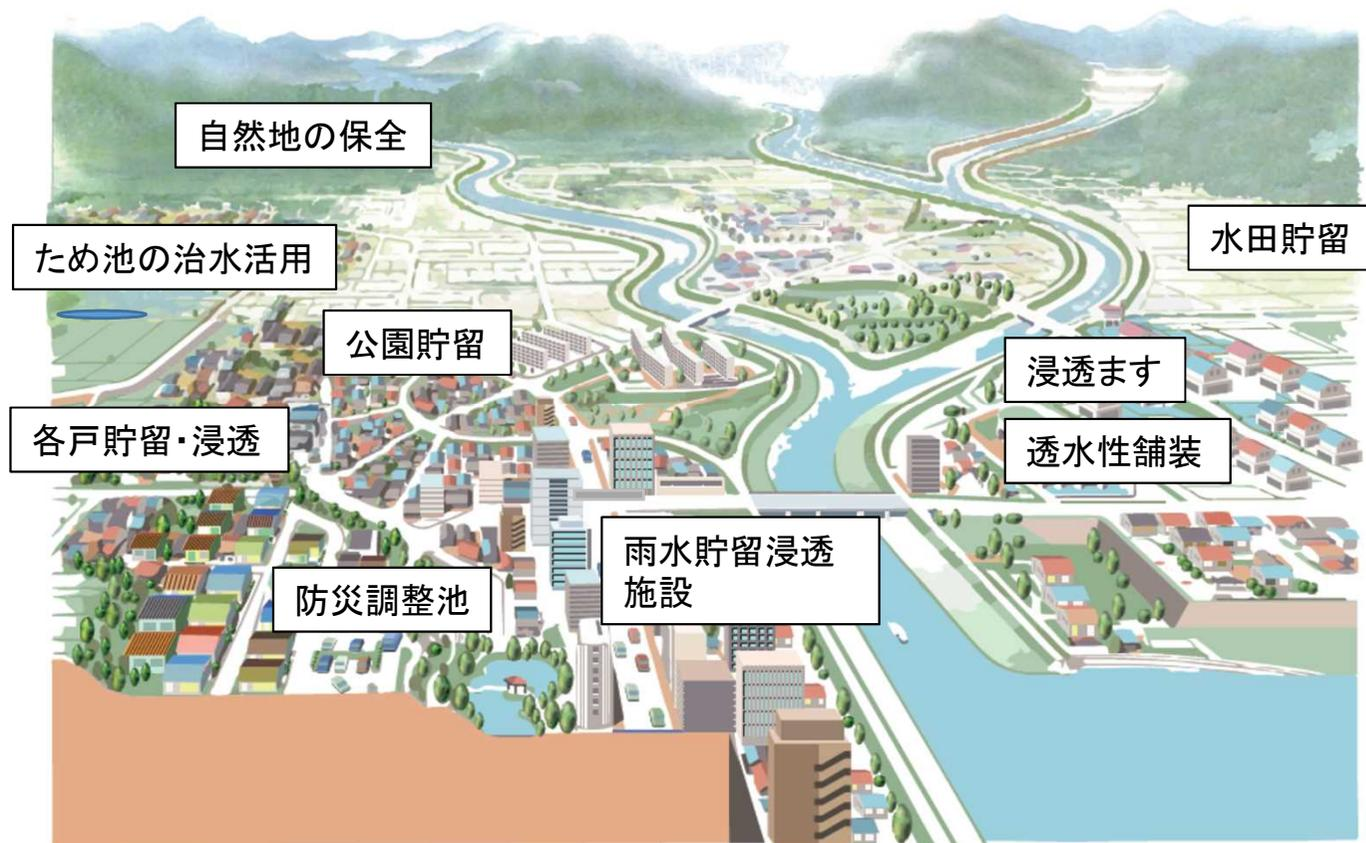
宅地造成等によって、雨水が地下に浸透せず、河川等に一度に流出して浸水被害をもたらす
