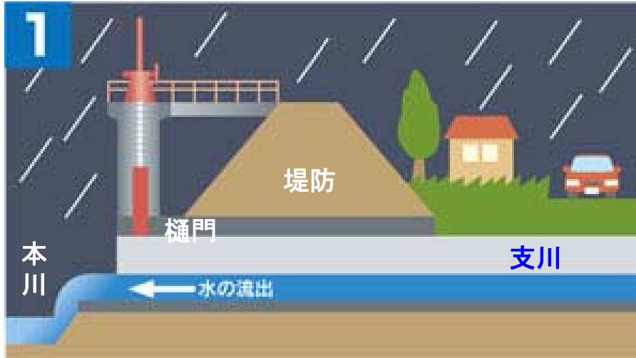
本川の水位が低い時は、樋門を開いた状態で、支川から本川へ水は流れます。
