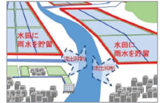
水田に雨水を貯留し 下流への流出を抑制
