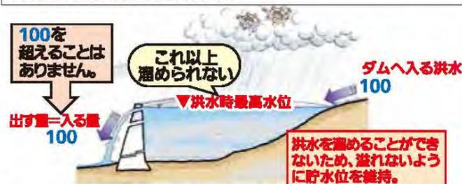
自然河川状態(ダムに入る洪水=ダムから流す量)でのダムの操作を維持。
