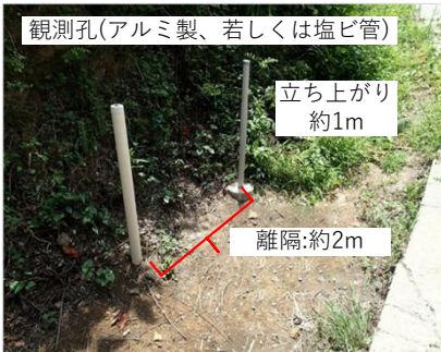
ボーリング調査後は観測孔を設置し、地下水等を観測します。
