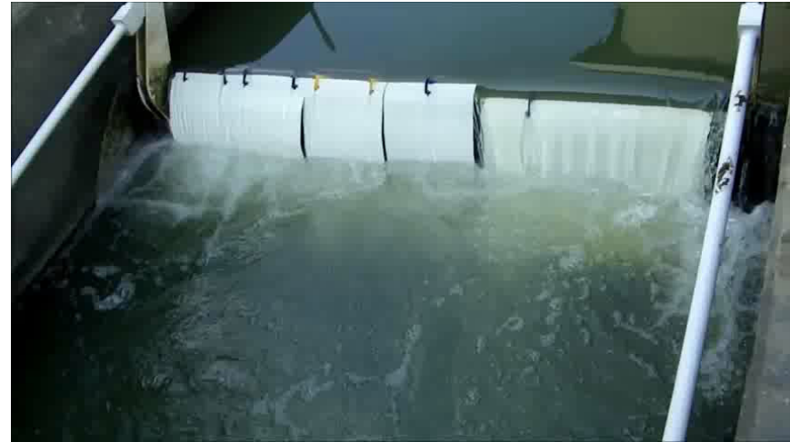
金属板表面の流れに乗って遡上する行動が見られる
