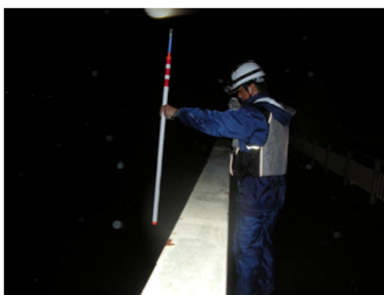
高水流量観測の実施状況
