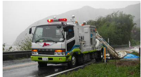
排水ポンプ車の出動状況
