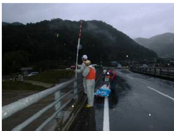
高水流量観測の実施状況
