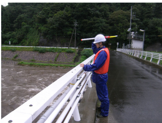
高水流量観測の実施状況
