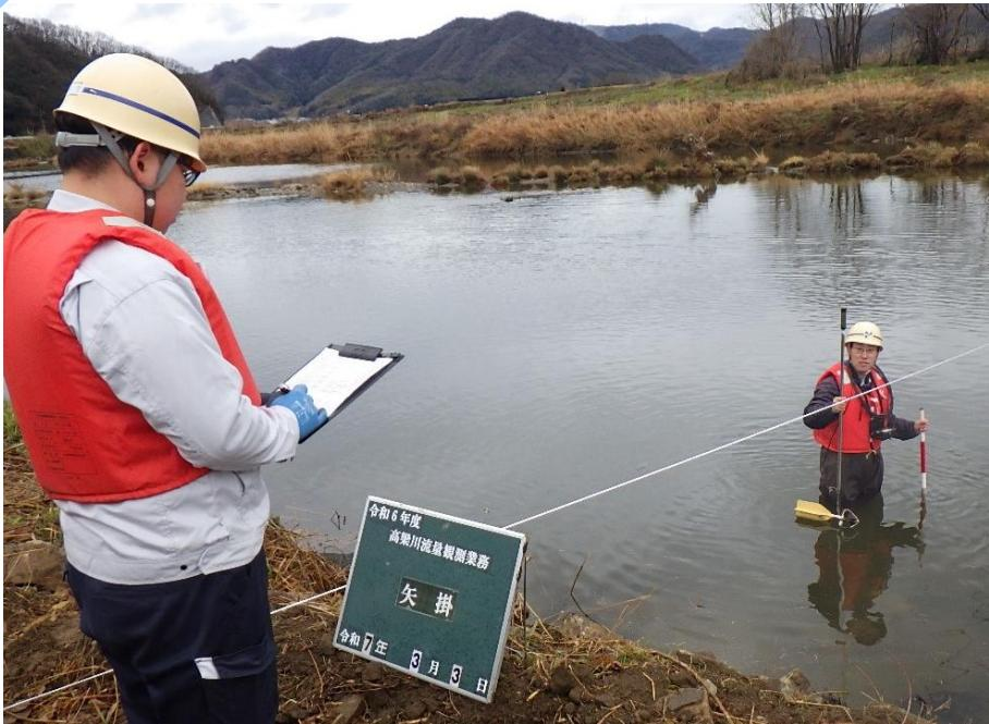
洪水時の流量観測は、危険を伴い多くの人手が必要でした。そこで、カメラ映像から流量を解析するDX（デジタル技術）の活用が期待されています。しかし、対象の「日羽観測所」は川幅が100m以上と広く、映像の精度を保証するための目印（標定点）となる構造物がありませんでした。
