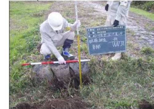
石張りは「一層」
