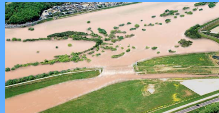
【計画洪水時の分流イメージ（旭川流量：6,000 \text{m}^3/\text{s} ）】
