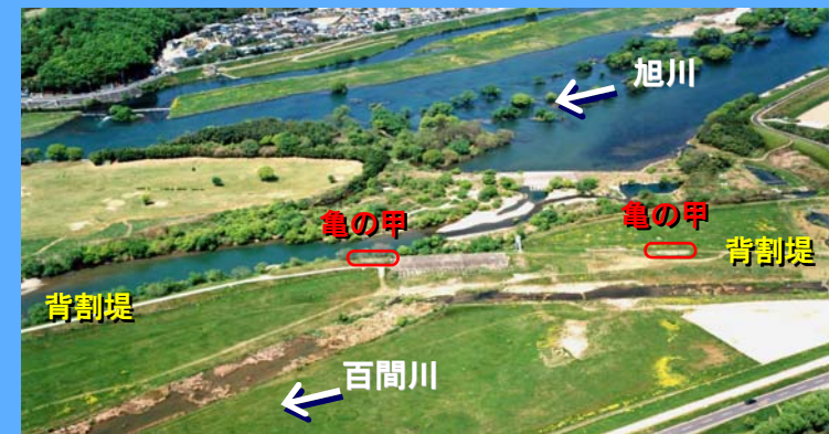
【分流開始時の分流イメージ（旭川流量：約1,700 \text{m}^3/\text{s} ）】
