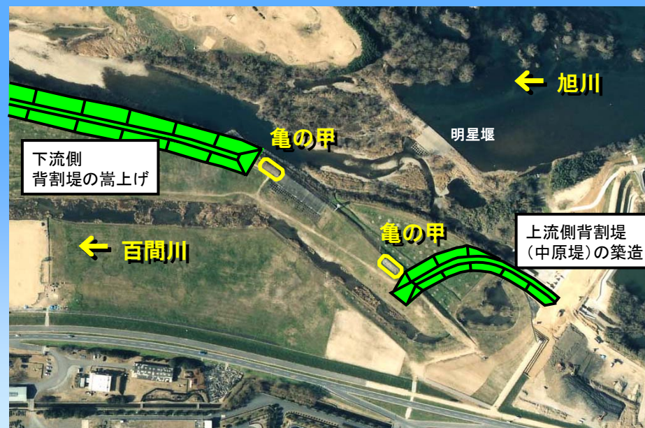
【現況河道模型の改良概念図：背割堤の嵩上げ、築造】
