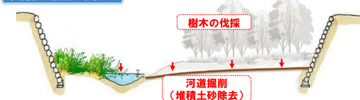
実施後（掘削・伐採）
