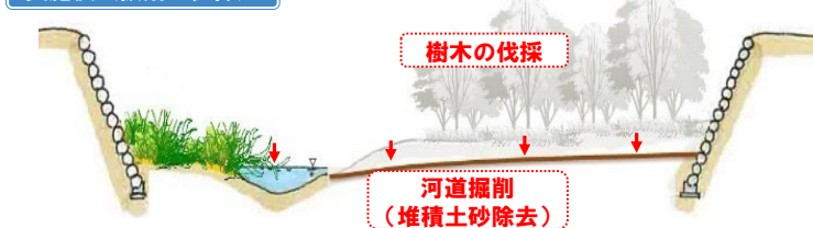
実施後（掘削・伐採）
