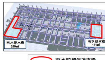
雨水貯留浸透施設
