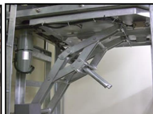
換気口浸水防止機
