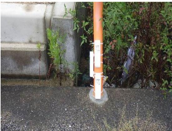
センサー設置状況 (浸水多発箇所)
