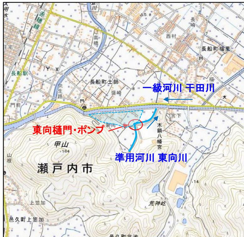
一級河川 干田川が増水、水位上昇の際は、準用河川 東向川に逆流しないように、樋門を全閉とする。その際、東向川の内水は排水ポンプを稼働させ、排水することで、地域内の浸水を防ぐ。
