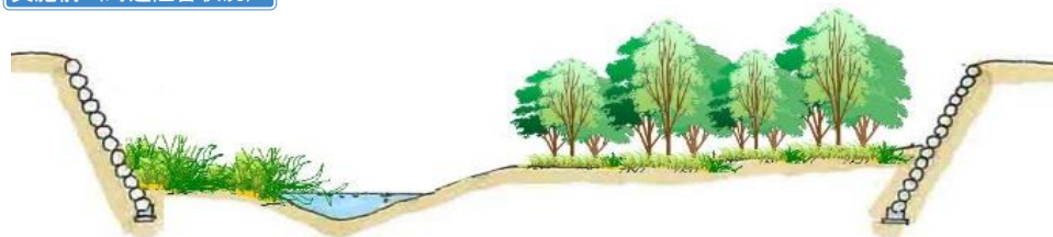
実施前(河道阻害状況)
