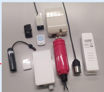
実証実験に用いている浸水センサ
