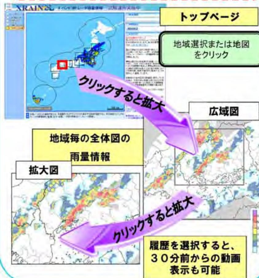
※Cバンドレーダ(波長5cm程度)は広域的な降雨観測に適するのに対し、Xバンドレーダ(波長3cm程度)は観測可能エリアは小さいものの局所的な豪雨をリアルタイムに高精度で観測することが可能。
