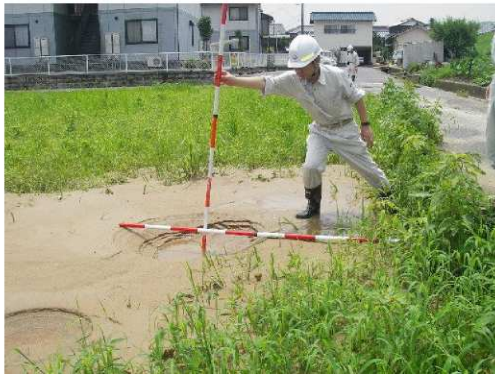
総社市清音 漏水発生状況 (H18.7 梅雨前線豪雨)
