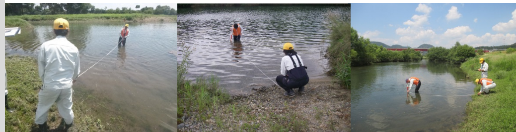
川底の深さを測定しています。
